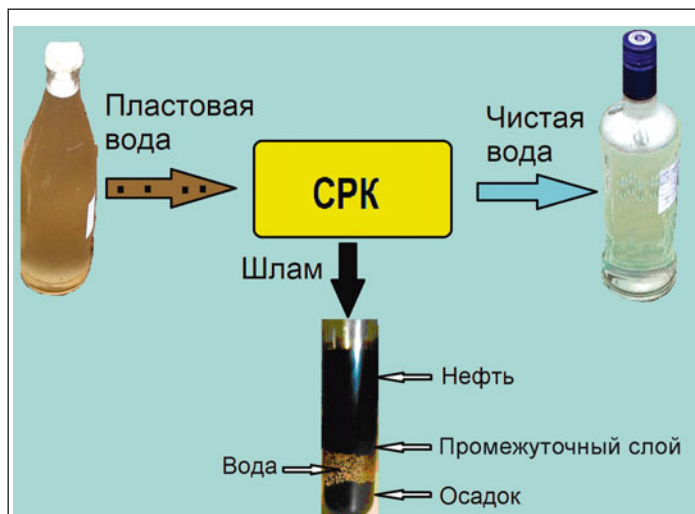
Рис. 4. Результат очистки воды в аппарате СРК
